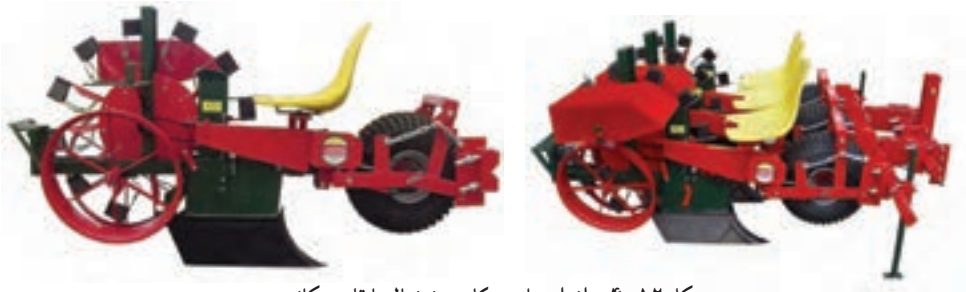
شکل ۱۲-۴- انواع ماشین کاشت نونهال یا قلمه مکانیزه
