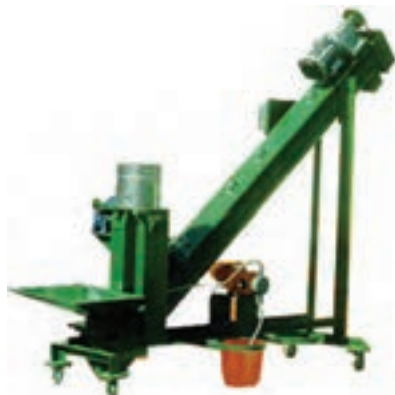
شکل ۳-۴- ماشین ضدعفونی‌کننده بذر
