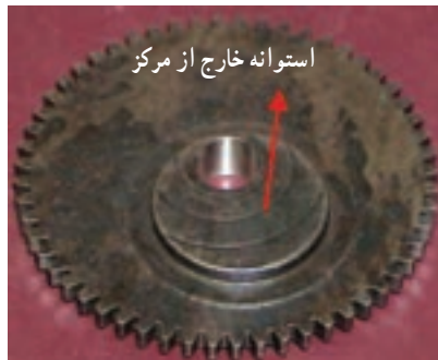
شکل ۲-۳۴- چرخ دنده بزرگ
