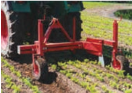
شکل ۱۵-۴- تیغه تراکتوری هرس ریشه
