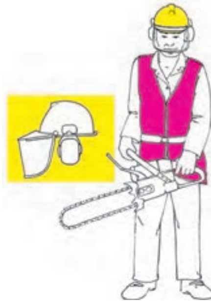
شکل ۱۵-۲- پوشش ایمنی کاربر اره زنجیری
