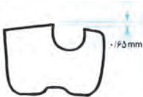
محدودکننده عمق صحیح ۰/۶۵ تا ۰/۹ میلی متر
