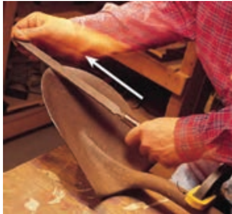
شکل ۱-۲- سوهان کاری لبه بیل
