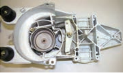
ب- پوسته کلاچ و جعبه دنده
