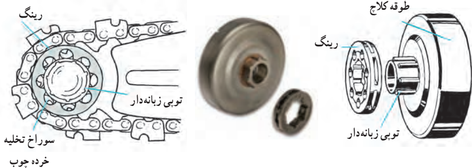
شکل ۷-۲- چرخ زنجیر رینگ‌دار
